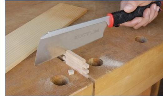
Eine Japansäge wie oben ↑ mit einem verstärkten Rücken ist ideal für Querschnitte, wenn du etwas absägen willst.
